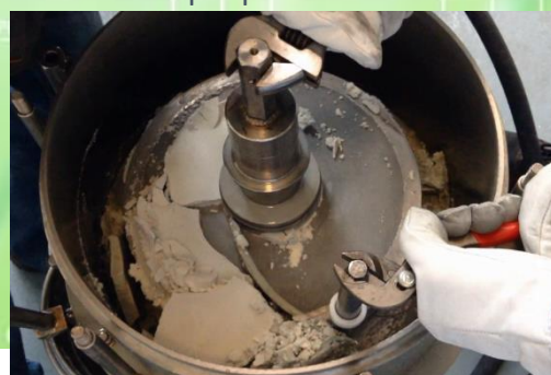
Démonstration du Filtre Multi-Plaques à débâtissage raclé (couvercle enlevé). Les dispositifs de raclage sont visibles sur le dessus de la plaque.
